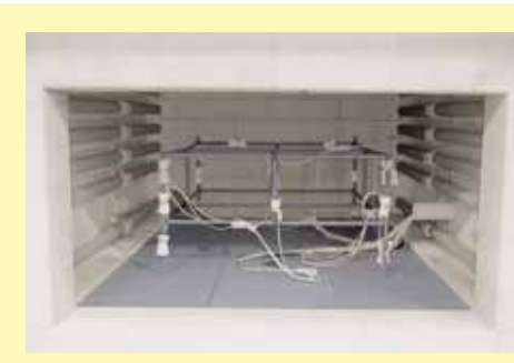
Messaufbau in einem Glühofen
