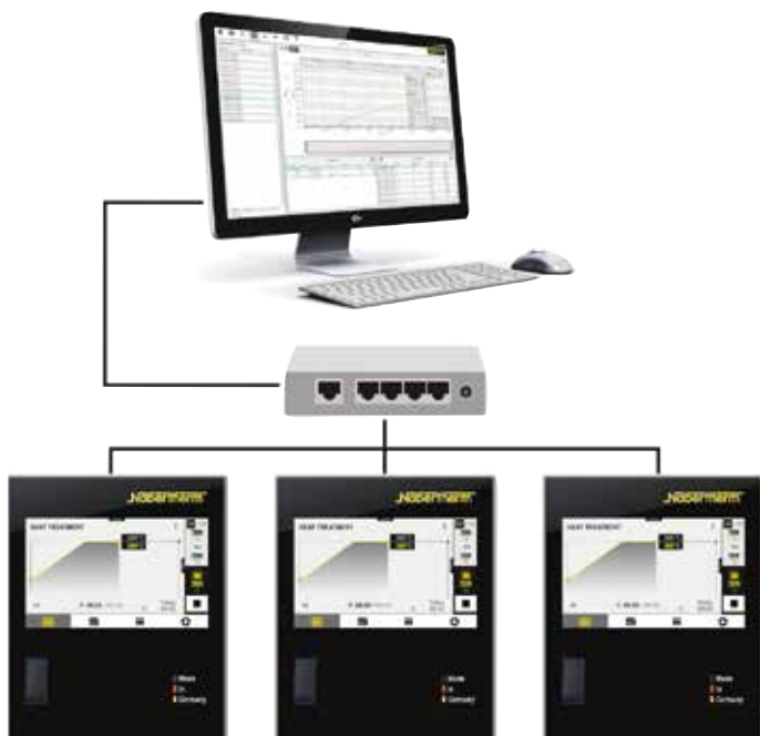
Ejemplo de instalación con 3 hornos
