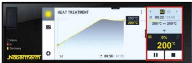
Resumen detallado de la información del proceso, incluido el punto de consigna, el valor real y las funciones principales
