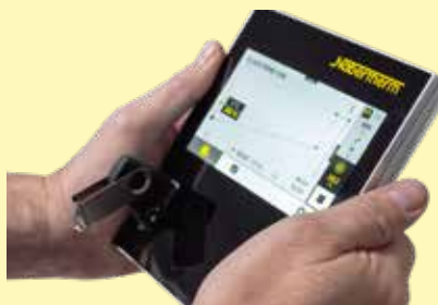
Inmatning av processdata från den anslutna styrenheten via USB-minne
