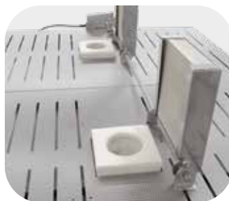
Automatisk frånluftslucka för snabb ugnskylning efter avslutad bränning
