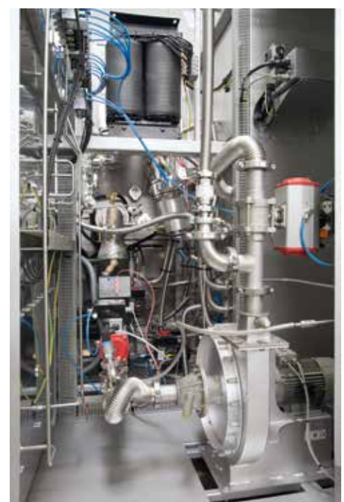
Refroidissement forcé du gaz pour four moufle étanche à paroi froide VHT 8/16-MO
