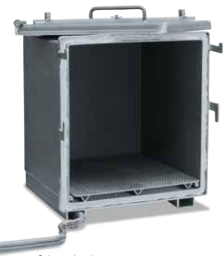
Caisson de mise sous gaz protecteur restant dans le four
