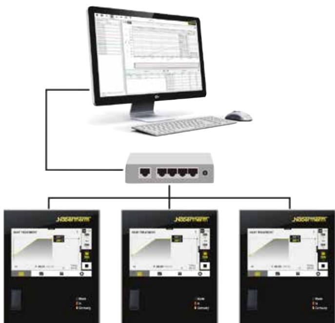
Exemple de montage avec 3 fours
