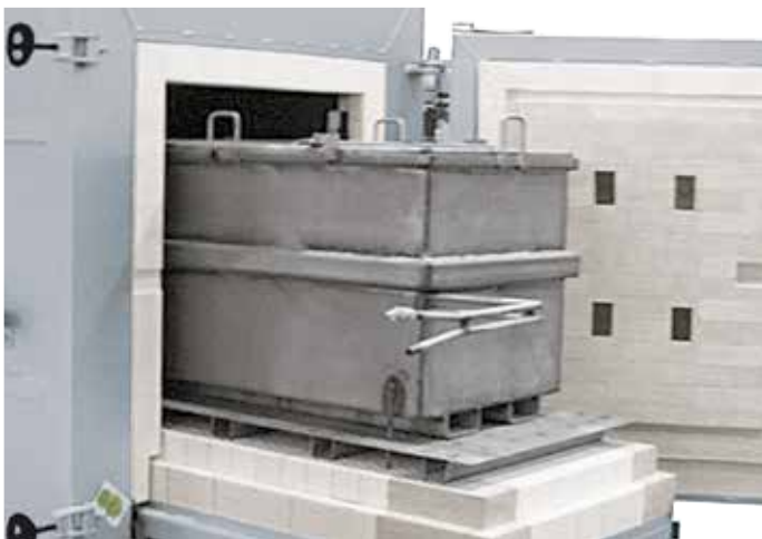
Caisson de grande dimension à utiliser dans un four à sole mobile et convection forcée
