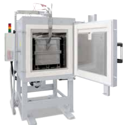
Four chambre à convection forcée N 250/85 HA avec caisson de mise sous gaz pour les traitements thermiques sous atmosphère au gaz protecteur
