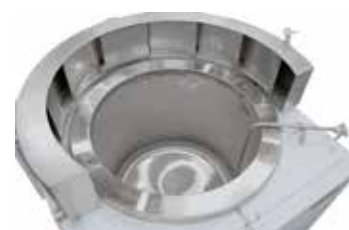
TS 90/80 avec un thermocouple de bain de sel pour le traitement thermique de l'acier
