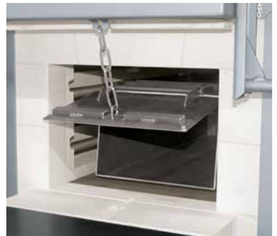
Caisson de recuit avec trappe ouvrant en même temps que la porte du four
