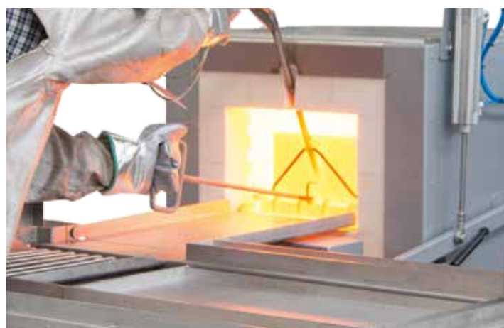
Système de trempes sous gaz protecteur avec four N 41/H
