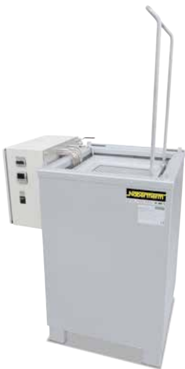
Bac de trempe Q 200 pour la trempe dans l'huile ou l'eau
