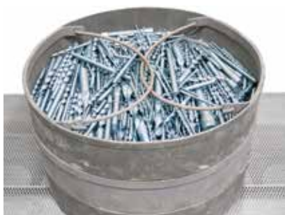
Bleuissement de forets à la vapeur dans un four de la série NRA voir page 16
