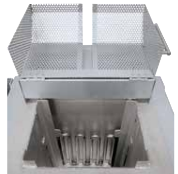
Résistances électriques dans le creuset
