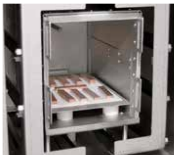
Traitement thermique de barres de cuivre sous hydrogène dans four moufle étanche VHT 8/16-MO
