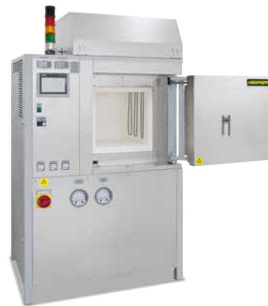
Four haute température HT 64/17 DB100 avec système de sécurité passif pour le déliantage et le frittage à l'air
