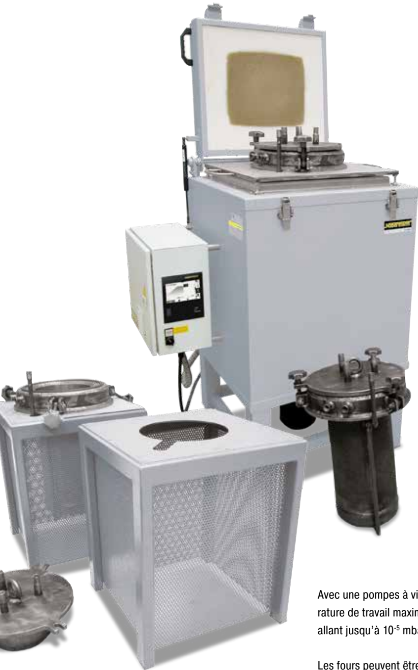
Four puits SAL 30/65 avec moufle étanche de rechange pour les atmosphères à gaz protecteur définies ainsi que 2 stations de refroidissement à moufle étanche
