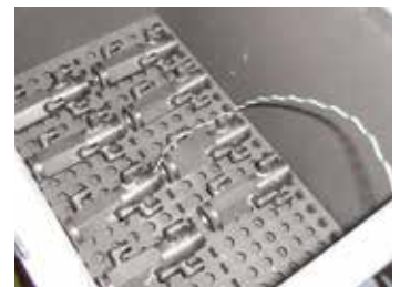
Soudobrasage dans caisson de mise sous gaz
