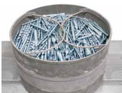
NRAシリーズの炉を使用した水蒸気によるドリルのブルーイング, 16ページ参照
