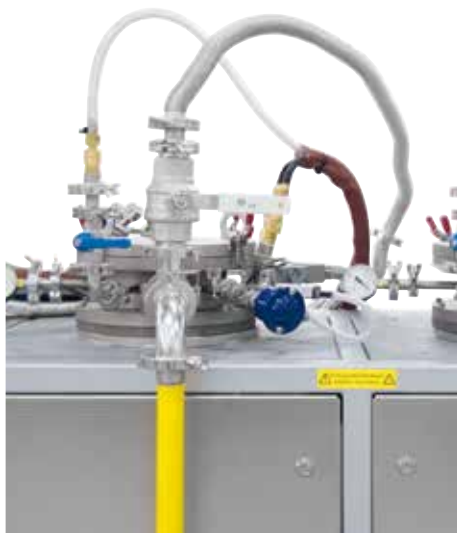
供給ラインと計測ラインのある交換可能なレトルト
