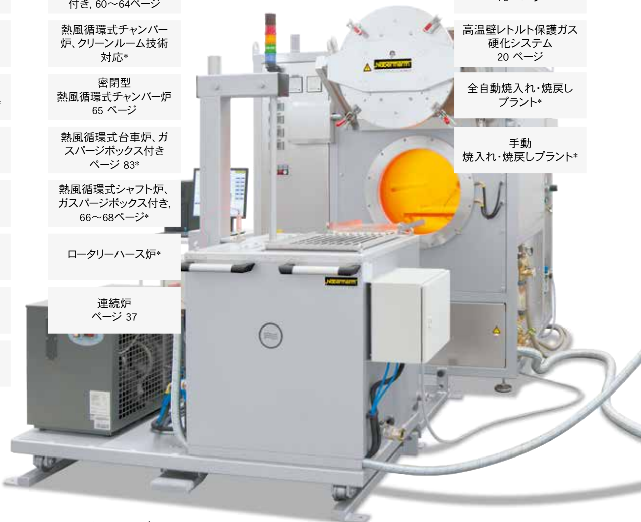
レトルト炉 NR 50/11 および水焼入れ槽のある半自動熱処理プラント
