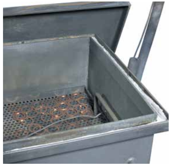
チャージ熱電対のあるガスパージボックス内での保護ガス雰囲気下での熱処理
