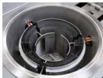
タングステンヒーターを装備した円筒状レトルト
