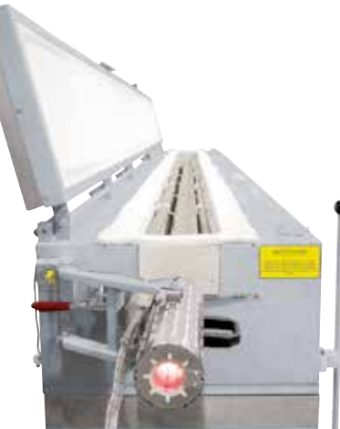
チューブ炉をベースにした長さ 6 メートルのワイヤー式連続炉
