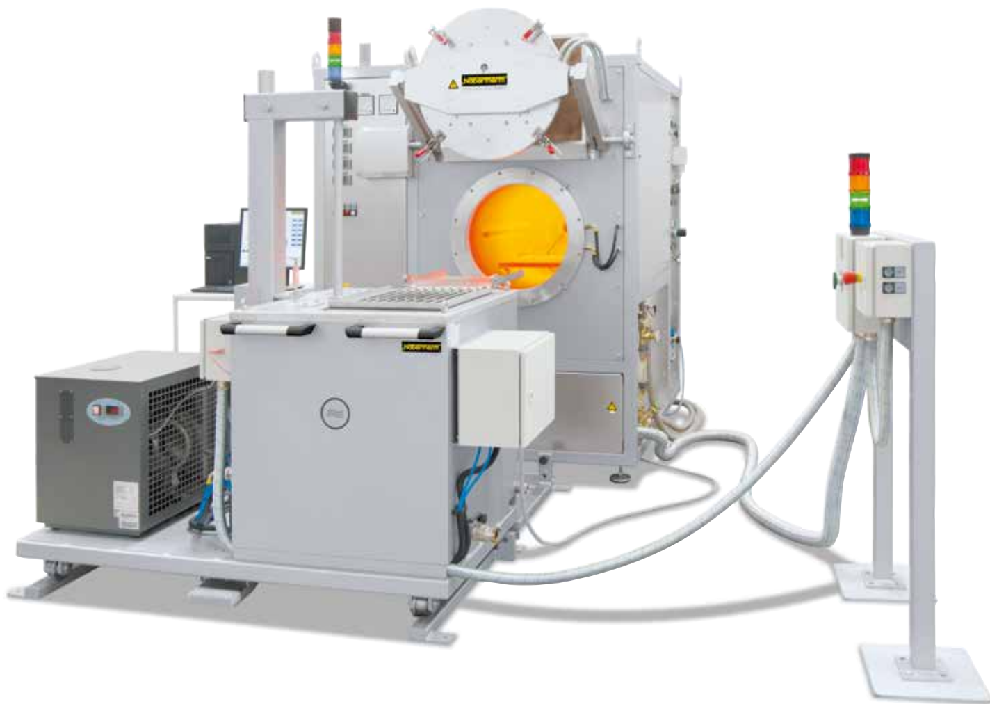
レトルト炉 NR 50/11 およびレール上の水焼入れ槽を備える半自動焼入れプラント
