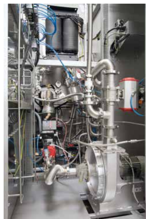
ファン冷却の低温壁レトルト炉 VHT 8/16-MO
