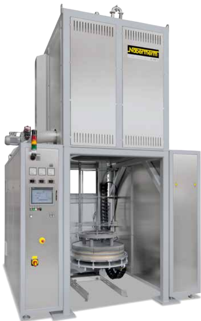
昇降底型レトルト炉 LBR 300/11 H 2 のガス管理システム
