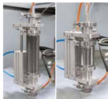
低温域では、自動引き出し装置のある熱電対タイプ S が優れた制御を提供します
