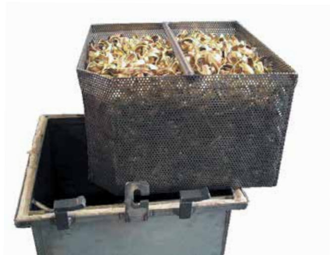
排気ができるアニーリングボックス内でのバルク材の光輝焼鈍
