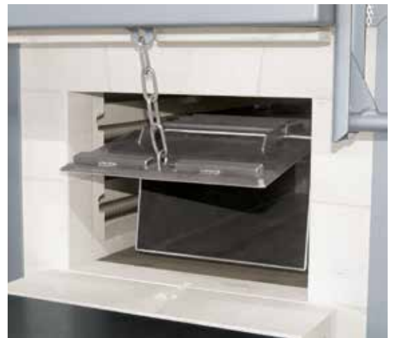
炉扉と一緒に開くフラップのあるガスパージボックス
