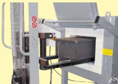
保護ガス雰囲気用のガス化ボックスのチャージ台車による作業
