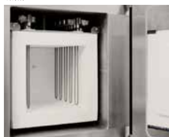
ファイバー断熱材付き二珪化モリブ デン熱器具
