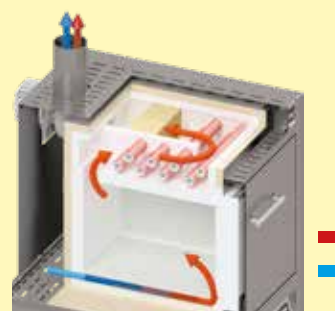
Schéma de principe du flux d'air dans le four d'incinération L 24/11 BO
