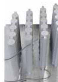
Tiges de traction en titane après le traitement thermique au four NR 50/11 sous atmosphère à l'argon
