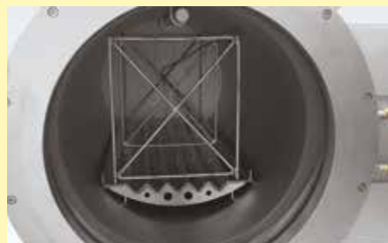
Plaque de chargement et montage d'essai TUS pour four moufle étanche NR 20/11
