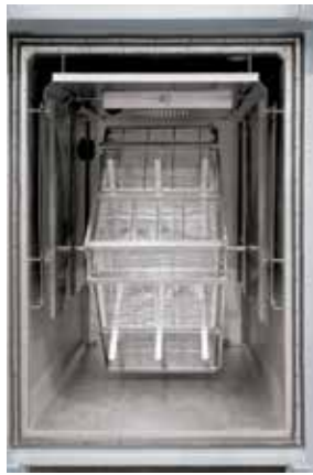
Dispositif rotatif à servomoteur avec des corbeilles en place pour faire tourner la charge pendant le traitement thermique
