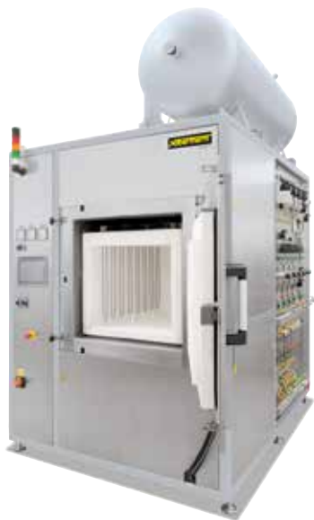
Four moufle étanche VHT 100/15-KE H 2 avec isolation en fibre et réservoir additionnel pour fonctionnement sous hydrogène, 1400 °C
