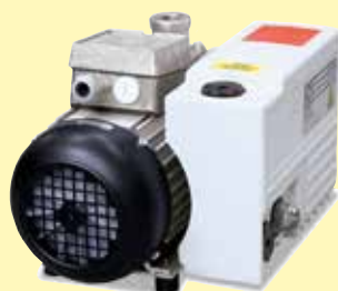
Pompe à tiroir rotatif à un étage pour traitements thermiques sous vide grossier jusqu'à 5 mbars
