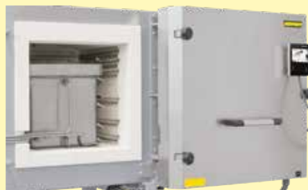
Porte pivotante parallèle pour ouverture à l'état chaud
