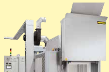
Four haute température HT 160/18 DB200-3 avec porte guillotine
