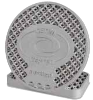
Pièces imprimées en aluminium, traitées à chaud dans le modèle N 250/85 HA (fabricant CETIM CERTEC sur plateforme SUPCHAD)
