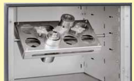
Dispositif rotatif électrique (dans le cas présent avec plate-forme personnalisée pour conteneur PARR)
