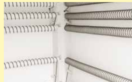
La conception du four LF permet des temps de chauffage et de refroidissement plus courts
