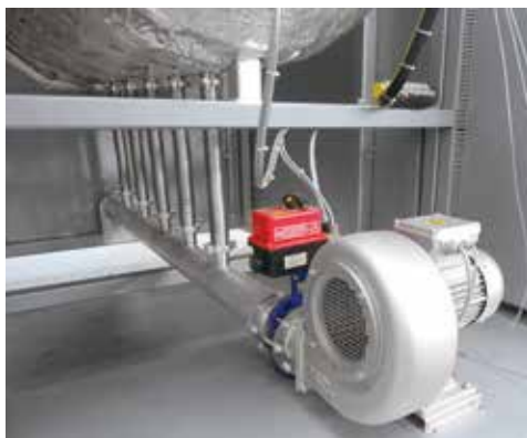
Refroidissement par ventilateur pour four moufle étanche à paroi chaude NRA 400/03
