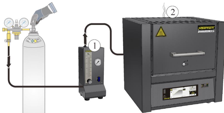
Fig. 50: Raccordement du système de gazage (figure similaire)
