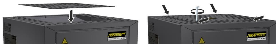
Obr. 19: Montáž krytu model LHT 01/17 D (podobne ako na obrázku)
