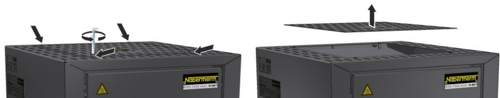
Obr. 44: Demontáž krytu model LHT 01/17 D (podobne ako na obrázku)
