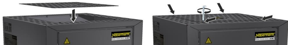
Obr. 51: Montáž krytu model LHT 01/17 D (podobne ako na obrázku)
