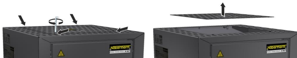
Obr. 17: Demontáž krytu model LHT 01/17 D (podobne ako na obrázku)
