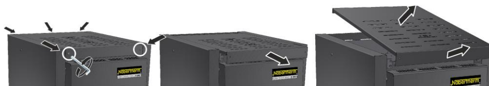
Obr. 37: Demontáž krytu model LHT 03/17 D (podobne ako na obrázku)
