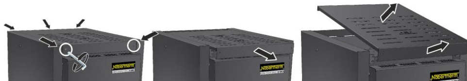
Obr. 56: Demontáž krytu model LHT 03/17 D (podobne ako na obrázku)
