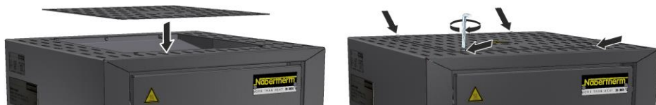
Obr. 39: Montáž krytu model LHT 01/17 D (podobne ako na obrázku)
