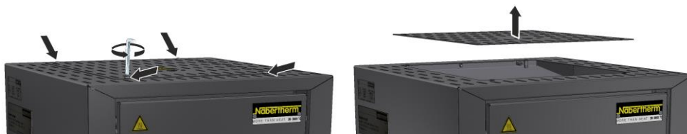
Obr. 36: Demontáž krytu model LHT 01/17 D (podobne ako na obrázku)
