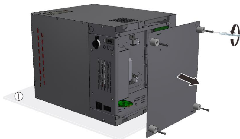
Obr. 54: Demontáž spodnej platne – model LHT 01/17 D (podobne ako na obrázku)
