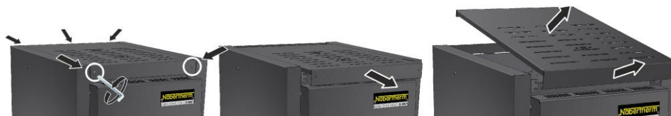
Slika 37: Demontaža pokrova – model LHT 03/17 D (podobno kot na sliki)
