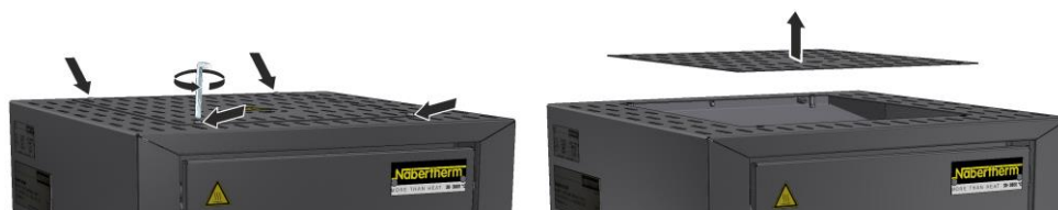
Slika 36: Odstranjevanje pokrova – model LHT 01/17 D (podobno kot na sliki)
