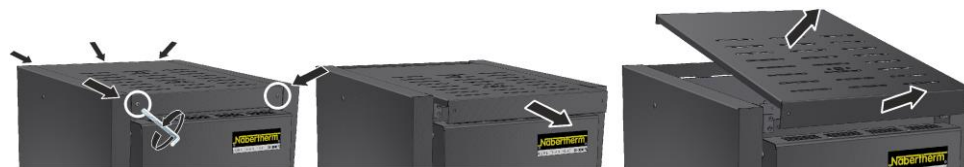
Slika 45: Demontaža pokrova – model LHT 03/17 D (podobno kot na sliki)
