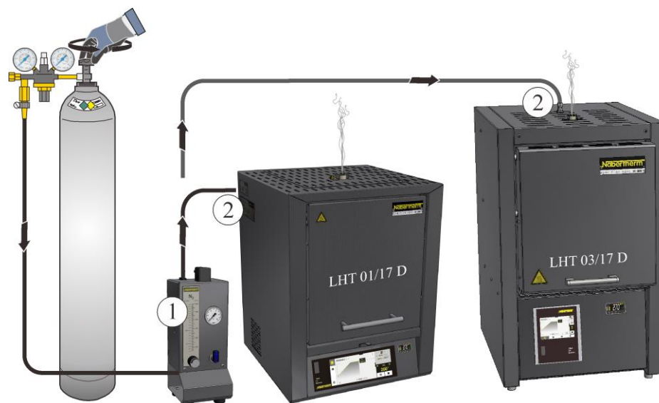
Slika 64: Priklučitev na sistem za dovajanje plina (podobno kot na sliki)
