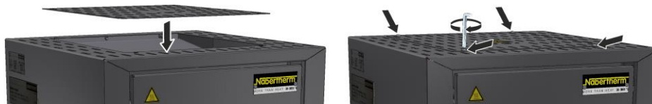
Slika 19: Montaža pokrova – model LHT 01/17 D (podobno kot na sliki)
