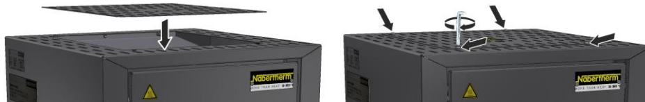
Slika 51: Montaža pokrova – model LHT 01/17 D (podobno kot na sliki)
