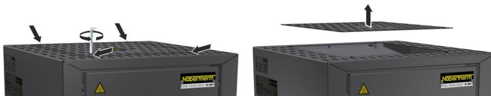
Slika 44: Odstranjevanje pokrova – model LHT 01/17 D (podobno kot na sliki)
